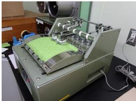
写真 2 摩擦試験機Ⅱ型（学振形）
