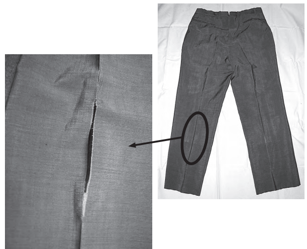
センターラインから破損したズボン
